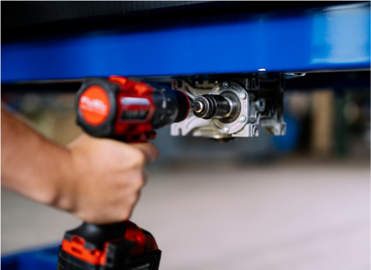
Abbildung: Antriebsschnittstelle für die Höhenverstellung mit Akkuschauber.
